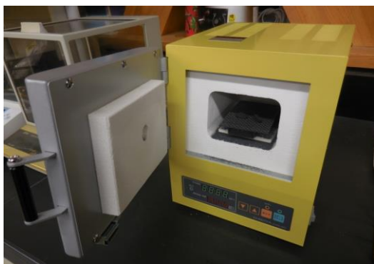
今回使用した電気炉 (中に固まった物質が 2 個入っている)
