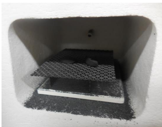
焼いた直後の電気炉の様子 (炉内に固まりきれずに飛び散った粉末が炉の下に溜まっている)
