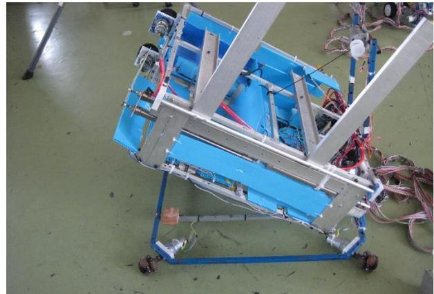
図7 ストック&発射機構を持ち上げた様子
