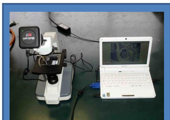
写真6 顕微鏡カメラシステム
