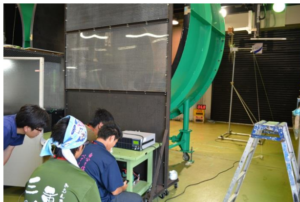
写真 6：組み立てた風車での電力計測
