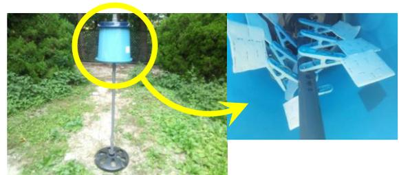
図 3. パッシブサンプラーを屋外スタンドに固定してバケツをかぶせて大気中で曝露している様子 (左)。バケツの中 (右)
