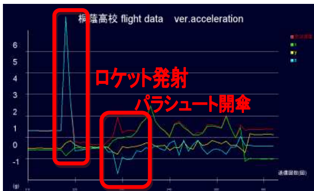
図 18. ロケット発射時の加速度データ(縦軸は重力加速度 [g], 横軸は時間[秒])
