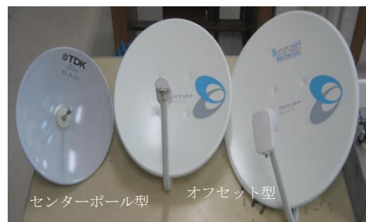
図 1 実験で使用した BS アンテナ
