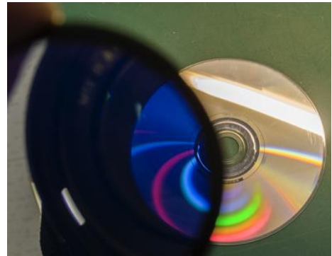
写真 2：光害カットフィルターの働き。特定の波長の光をカットして、 H\alpha 線などだけを透過する働きをします。CD の裏を透かして見ると、虹色の反射の一部がカットされているのがわかります。
