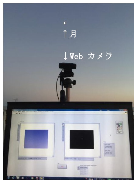
図 3 Web カメラの映像から天体の座標を読み取るプログラムの様子
