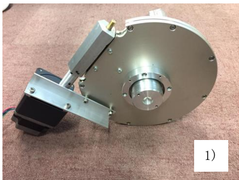
図2 1) (株)輝星に作製して頂いたウォームユニット、2) ナスミス高位軸に取り付けた様子
