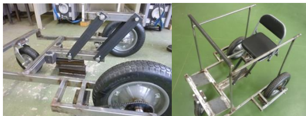
【写真3】四節リンク機構と組み上がった車椅子
