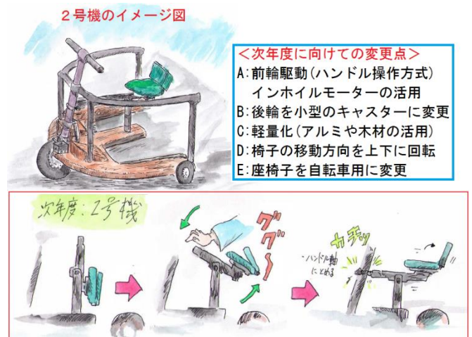
【図4】改良型のイメージと椅子の持ち上げ機構
