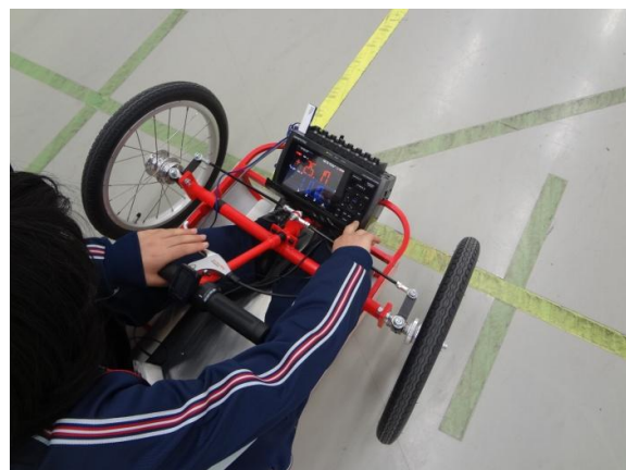
データロガーによるモータの電流・電圧測定
