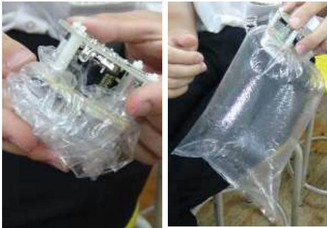
図2. エアバッグ (左は作動前、右は作動後)
