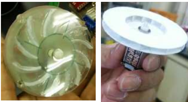
図3. エアバッグに使用する遠心ファン (左は紙製、右は一部プラスチック製)
