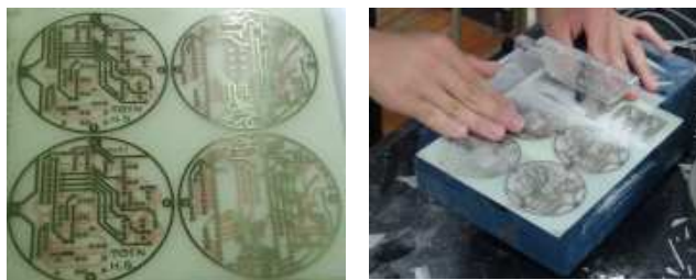
図8. エッチング後の基板と基板カットの様子
